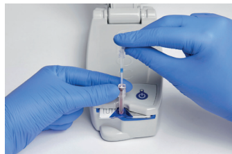
Probe entnehmen und Kapillare einsetzen
